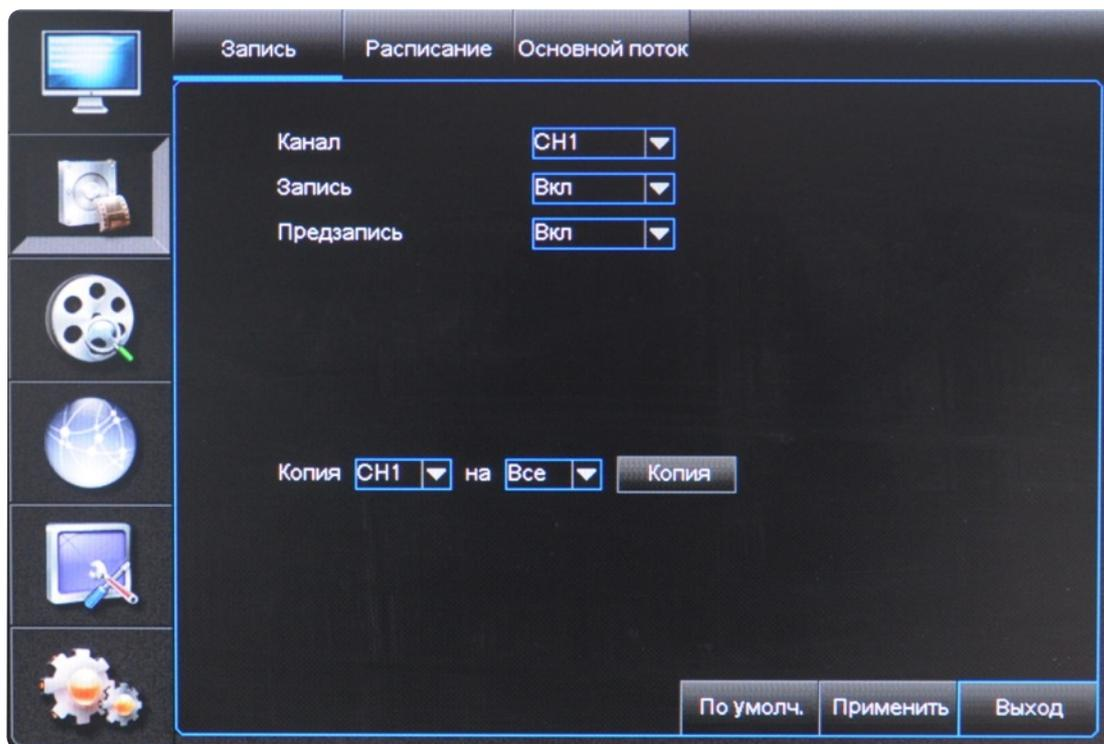
Включение и отключение записи по каждому конкретному каналу.
