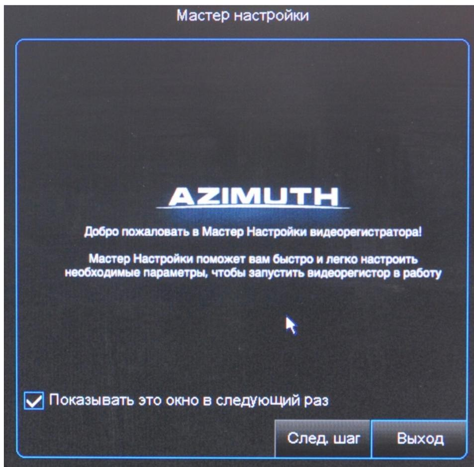
При первом запуске видеоре­гистратора запускается «Мастер настройки». Мастер настройки позволяет настроить основные функции видеоре­гистратора: подготовка HDD, расписание записи, основные настройки системы, настройки сети. При снятии галочки в поле «Показывать это окно в следующий раз», в следующий раз Мастер настройки появляться не будет.
