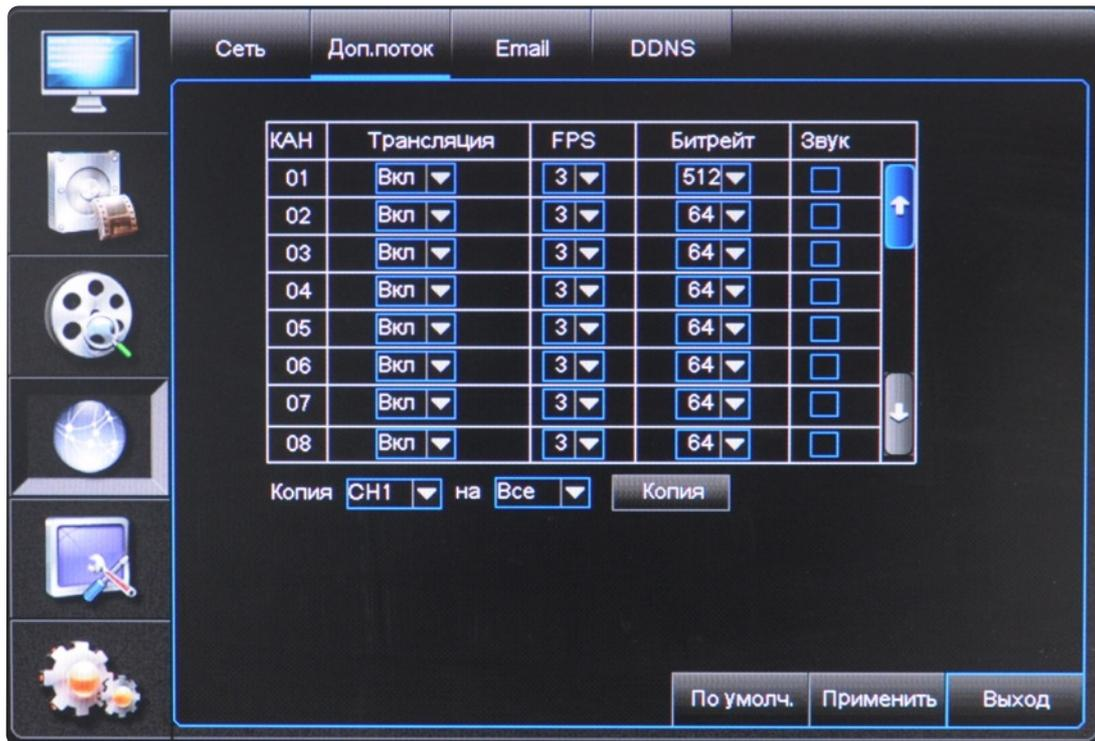
Доп. поток – дополнительный поток – используется для удаленного доступа с мобильных устройств, а также при медленном интернет-соединении. Если «Основной поток» – это, прежде всего, настройка качества записи видео, то «Доп. поток» – это настройка качества трансляции. Здесь у вас есть возможность задать альтернативные настройки для облегчения, уменьшения ширины потока, жертвуя качеством и темпом кадров.
