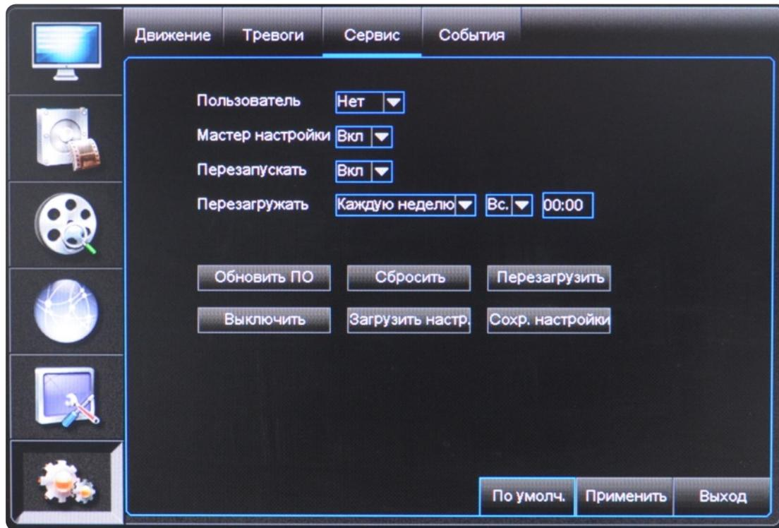
Обновление прошивки, перезагрузка и выключение регистратора, импорт и экспорт настроек и другие сервисные функции.
